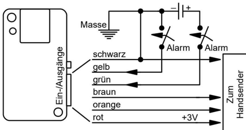
Abbildung 5: Verfügbare Anschlüsse bei Anschluss an den Handsender Audi 4H0 963 511 B
