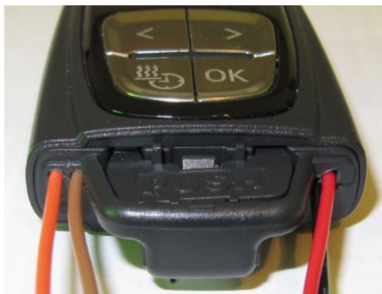
*Abbildung 3: Kabelführung von der Schnittstelle am MicroGuard-USB zur Platine des Handsenders 4H0 963 511 B von Audi*
