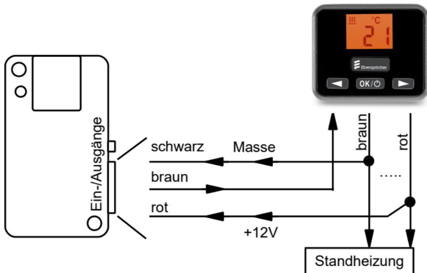
Abbildung 3: Ansteuerung über die Uhr EasyStart Select
