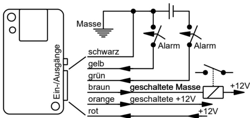
Abbildung 2: Prinzipielle Beschaltung des MicroGuard-USB Moduls
