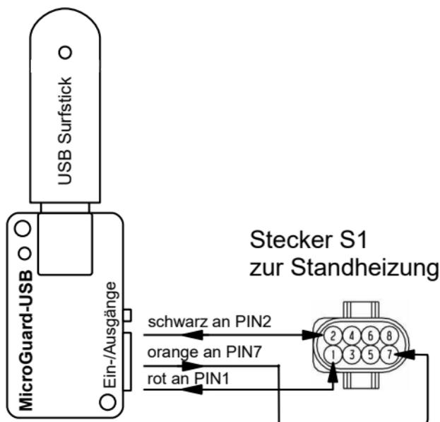
Abbildung 3: Anschluss des MicroGuard-USB Moduls an die Leitungen am Heizgerät
