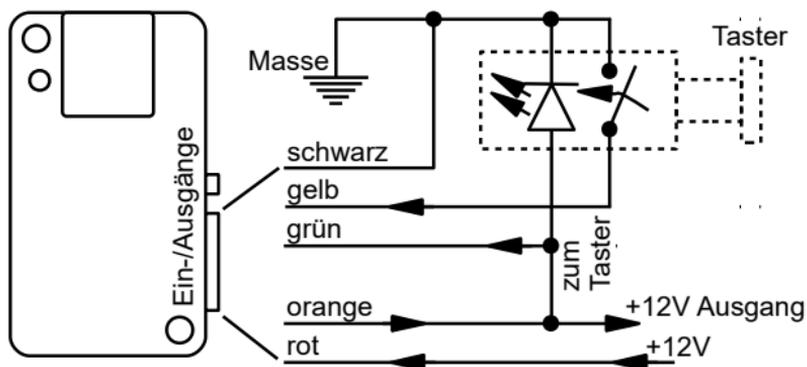
Abbildung 4: Beschaltung von MicroGuard-USB für die Rückmeldefunktion (grüne Leitung an orange) und einen Ein-/Aus-Taster (optional)
