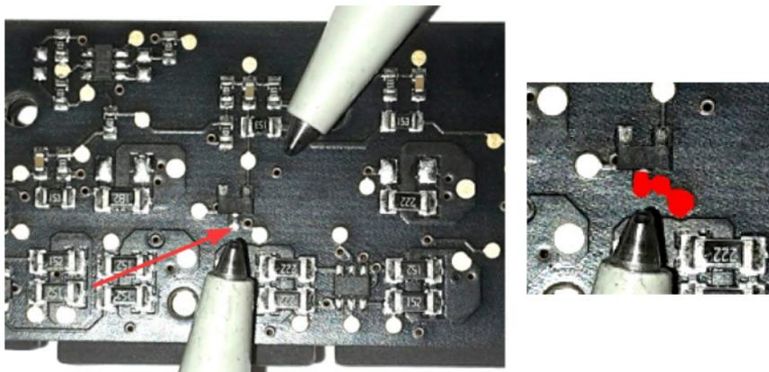
Abbildung 4: Anschlusspunkt für die braune Leitung von MicroGuard-USB
