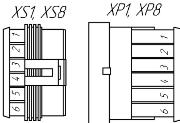
*Abbildung 4: Buchse (rechts, zum Heizgerät) und Stecker (zum Bedienelement). An die Zuleitungen der Buchse wird das Modul angeschlossen.*
