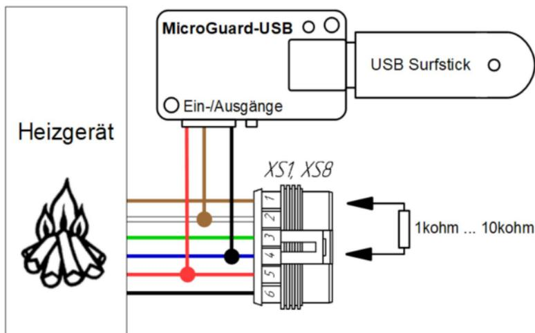
Abbildung 5: Schematische Darstellung des Anschlusses an PLANAR-Heizgeräte. Die Heizleistung kann mit einem Widerstand zwischen 1kOhm und 10kOhm eingestellt werden.
