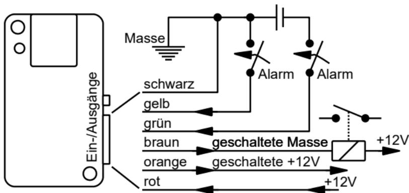
Abbildung 2: Prinzipielle Beschaltung des MicroGuard-USB Moduls
