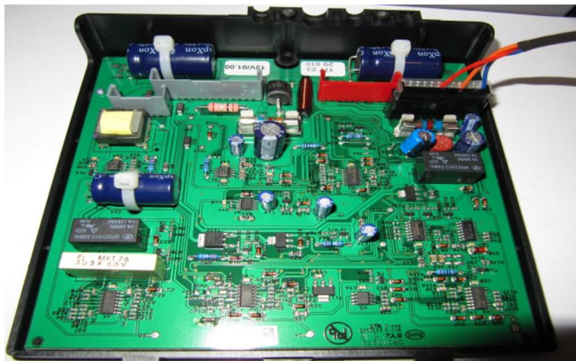
Abbildung 4: Steuerplatine der Truma e2400 und e4000, Zubehörschnittstelle
