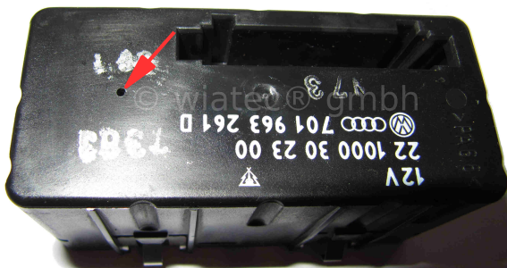
Abbildung 4: Öffnung für Kabeldurchführung, braune Leitung, Anschluss an Heiztaste
