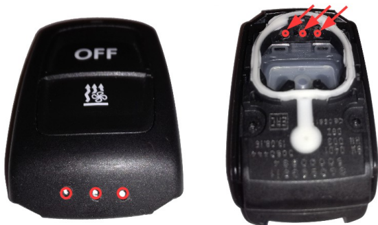
Abbildung 4: Kabelführung von der Schnittstelle am MicroGuard-USB zur Platine des Handsenders T91R von Webasto
