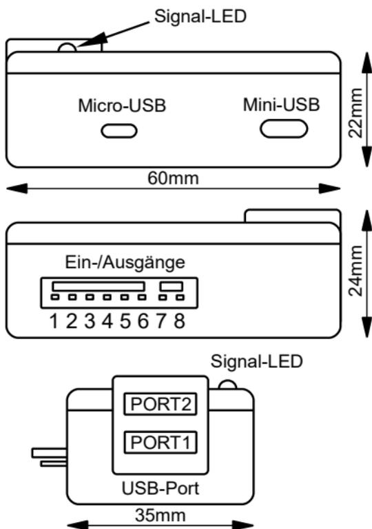
Abbildung 1: Aufbau und Abmessungen des MicroGuard-USB Moduls
