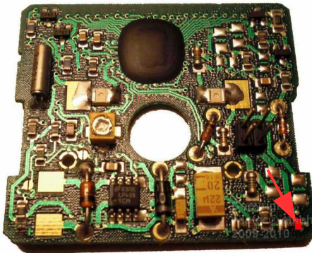
Abbildung 3: Anschlusspunkt für die braune Leitung vom MicroGuard-USB an die Platine der Vorwahluhr 1530, Version II/
