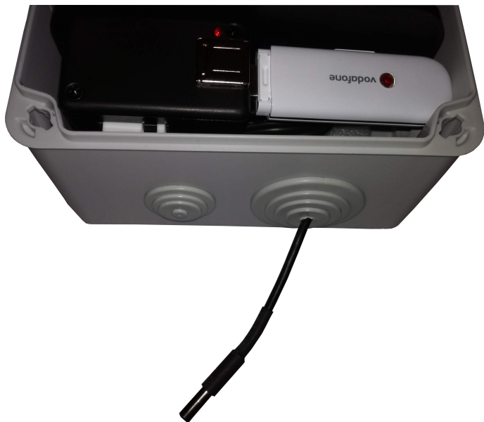
Abbildung 2: Aufbau des MicroGuard-USB Systems zur Bodenfrosterüberwachung, innen-liegendes Alarmmodul
